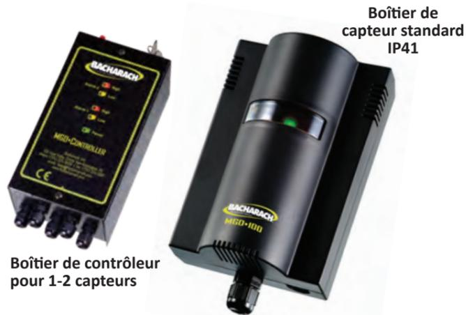
Boîtier de contrôleur pour 1-2 capteurs
