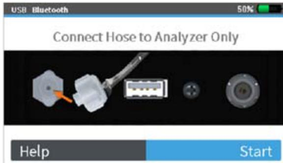
Figura 5 Pulse Start para iniciar la calibración de aire
