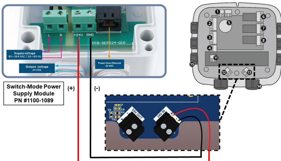
Localice el bloque de terminales de entrada de +24 VCC (# 13) y desconéctelo del controlador.
