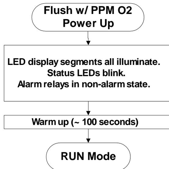
FIGURE 25 POWER UP DIAGRAM
