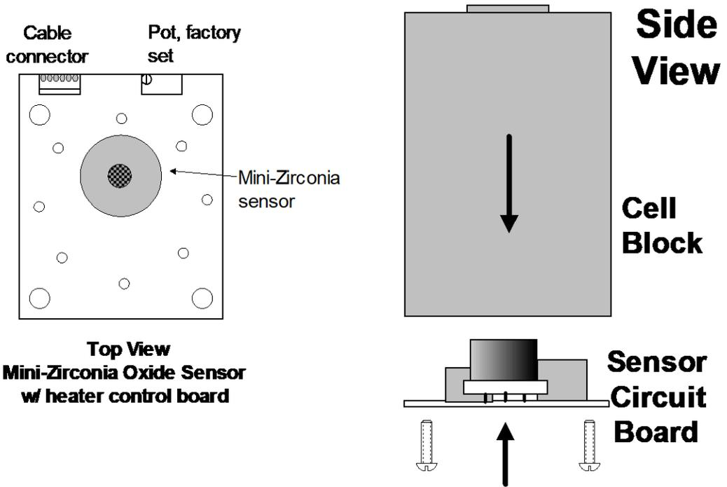
**MINI-ZIRCONIA SENSOR / CONTROLLER BOARD**
