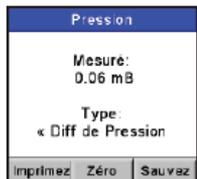
**SAUVER (F3)** : Sauvegarde les données actuellement affichées sur l'écran ACL en mémoire. Jusqu'à 500 enregistrements individuels de test de combustion, température et pression peuvent être sauvegardés. Lorsque 500 enregistrements ont été sauvegardés, la mémoire doit être nettoyée pour pouvoir sauvegarder des données supplémentaires. L'analyseur n'écrasera pas des données anciennes.
