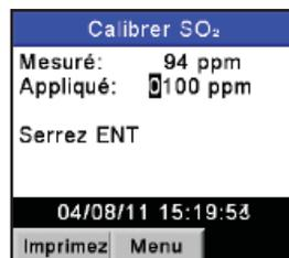
*Si la sortie du capteur est trop basse pour être exploitable, alors le message « Calibrage incorrect, Capteur en fin de vie, Saisie non sauvegardée » apparaîtra suivi de l'écran LISTE DE CALIBRAGE affiché de nouveau. Le capteur sera désormais marqué comme « MAUVAIS » sur l'écran DIAGNOSTICS.*
