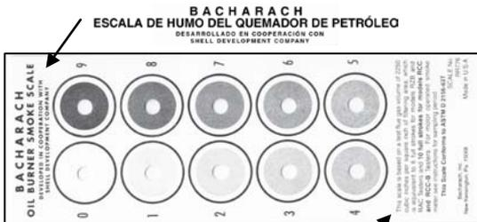
Esta escala se basa en un volumen de gas combustible de prueba de 2250 pulgadas cúbicas por pulgada de área de filtrado, lo que es equivalente a 6 velocidades completas para modelos de Probadores RZB y RAC y 10 velocidades completas para modelos de Probadores RCC y RCC-B. Para medidores de humo operados a motor consulte las instrucciones para el período de muestreo.
