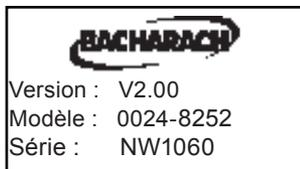
Appuyez sur le bouton **PWR** pour mettre l'analyseur sous tension. Les informations de version du logiciel, modèle et numéro de série de l'appareil seront affichées brièvement.
