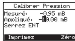
« Mesuré » est la valeur de pression actuellement détectée par le capteur de pression. « Appliqué » est une valeur de pression connue qui sera appliquée pour les besoins du calibrage.
