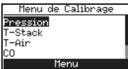
7. Utilisez les boutons **▲▼** pour mettre en surbrillance le capteur à calibrer, puis exécutez la procédure de calibrage pour ce capteur comme décrit aux chapitres suivants.
