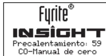
Auto-cero (Auto Zero): Cuando el canal de CO se establece en cero automático, el sensor de CO se pone a cero según el nivel de CO ambiente durante la puesta en marcha.
