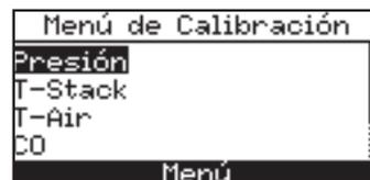
*“Medido” es el valor de la presión que actualmente detecta el sensor, mientras que “Aplicado” es un valor establecido de presión que se aplicará para realizar la calibración.*
