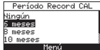
**NOTA:** Las configuraciones de fecha y hora deben ser correctas para que los recordatorios de calibración sean precisos.
