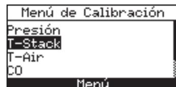
*“Medido” es la lectura de temperatura actual, mientras que “Aplicado” es una temperatura establecida que se aplicará para realizar la calibración.*
