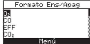
Restablezca el formato de visualización según la configuración predeterminada de fábrica de la siguiente manera:
