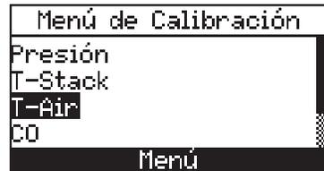
2. Si aún no lo hizo, encienda el analizador y despliegue la pantalla LISTA DE CALIBRACIÓN de acuerdo con la Sección 5.2.
