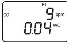
Voir la section 4.5.1 pour des explications sur le relevé de CO. Les données de pression affichées sont la différence entre la pression à l'orifice « + » et à l'orifice « - » du brûleur, lorsque la sonde 24-7267 ou 24-7266 est utilisée. Ce chiffre indique le niveau de tirage de la cheminée.
