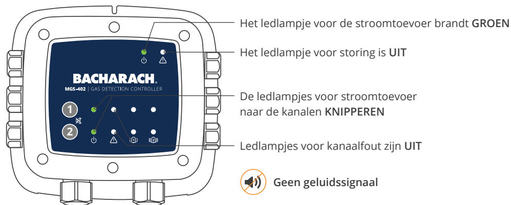
Afbeelding 4-2 - Inspectie van de MGS-402
