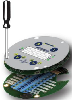
A continuación, desconecte con cuidado el conjunto de la luneta del visor y la placa del procesador (que queda conectado) de la placa de interfaz inferior desenroscando los 3 tornillos cautivos. Acceda a los tornillos cautivos a través de los orificios de la luneta del visor.
