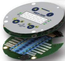
Prozessorplatte (mittlere Schicht) mit kodiertem Bandkabel
