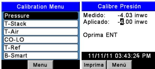
**Figura 6-2. Calibración del sensor de presión**
