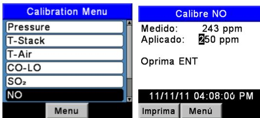
Figura 6-10. Calibración del sensor de NO
