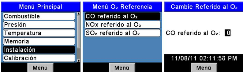
Figura 4-8. Configuración de la referencia de **O<sub>2</sub>**
